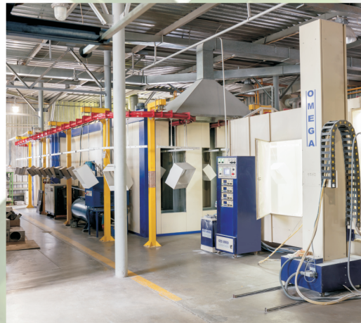
Автоматическая линия порошковой покраски ESTA-OMEGA (Турция)
