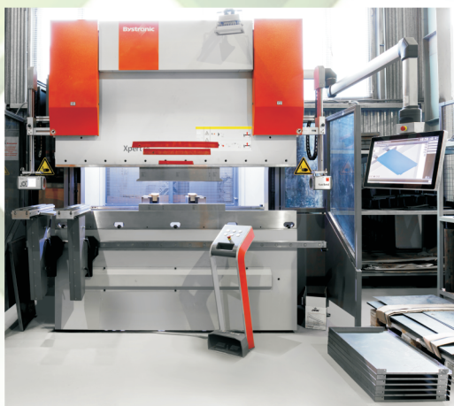
Кромкогибочные пресса BYSTRONIC Xpert (Швейцария)
