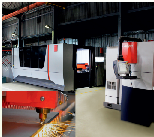
Высокоточная установка лазерной резки с автоматической подачей металла BYSTRONIC BySmart Fiber 3015 (Швейцария)
